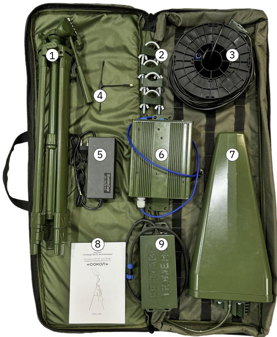
**Ретранслятор системы радиуправления БПЛА
